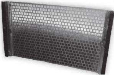
Кассета для вибросита Derrick FLC 500 Размер кассеты: 696 \times 1053 \pm 1-1,5 мм Высота (по замку): 40 \pm 1 мм Вес: 8 \pm 0,5 кг Тип: натяжная кассета
