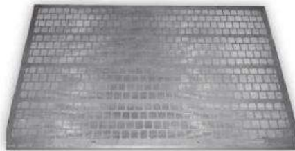
Кассета для вибросита GN ZS 703 Размер кассеты: 1250 \times 700 \pm 1-1,5 мм Высота: 31 \pm 1,5 мм Вес: 18 \pm 0,4 кг Тип: каркасная кассета
